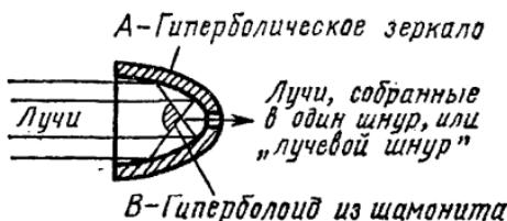
Лучи, собираясь в фокусе зеркала (А), падают на поверхность гиперболоида (В) и отражаются от него математически параллельно, — иными словами, гиперболоид (В) концентрирует все лучи в один луч, или в «лучевой шнур» любой толщины. Переставляя микрометрическим винтом гиперболоид (В), я по желанию увеличиваю или уменьшаю толщину «лучевого шнура». Потеря его энергии при прохождении через воздух ничтожна. При этом я могу довести его (практически) до толщины иглы.
